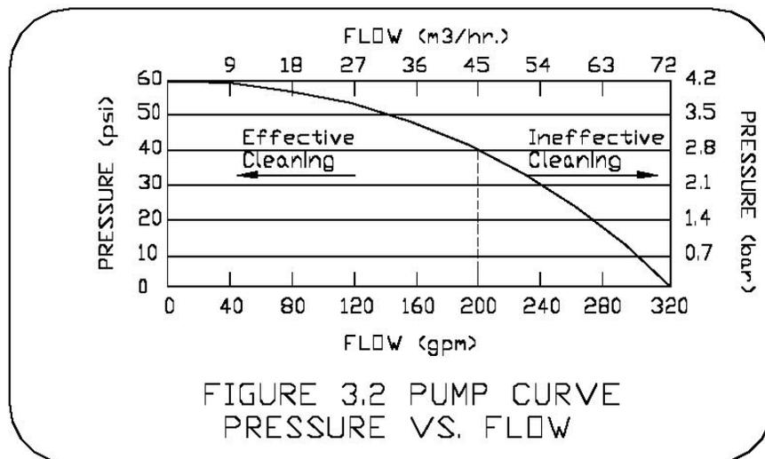
FIGURE 3.2 PUMP CURVE
