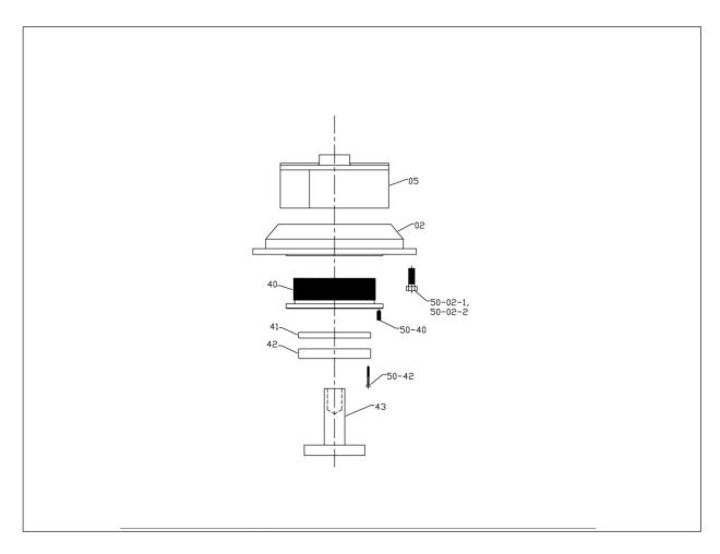
IMPELLER & SHREDDER ELEMENTS OF SKG 15C, 22C, 37C
